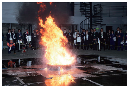
写真4 軽油の燃焼性状実験
